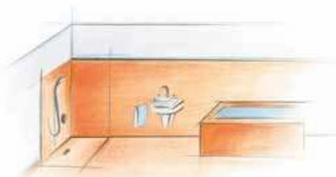
Места около душа, за умывальником и около ванн считаются мокрыми зонами, которые особенно сильно подвержены воздействию влаги. С помощью комбинированной гидроизоляции Schlüter-KERDI они могут быть рациональным образом защищены от проникновения влаги.
